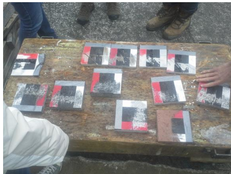
Test de nettoyage cryogénique sur des pierres
