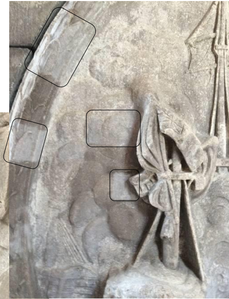
Tests avec différents abrasifs
