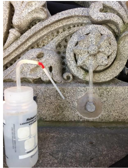
Test d'absorption et tube gradué RILEM avant et après consolidation
