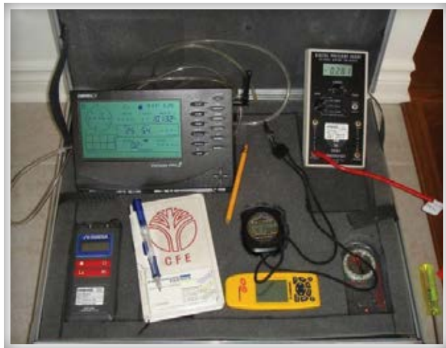
Figure 11 : Panneau de monitoring équipé d'un récepteur à distance de station météorologique et de micro manomètres numériques.
