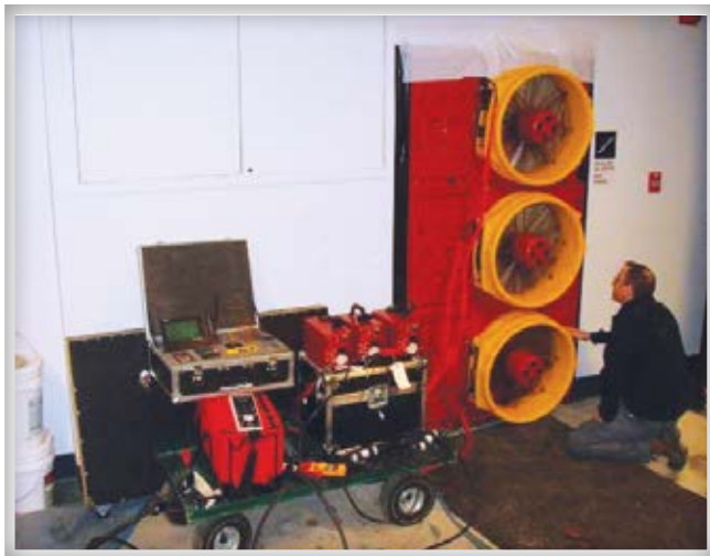
Figure 10 : Installation d'un système portatif de pressurisation doté de trois ventilateurs à haute puissance.
