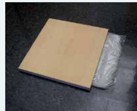
Échantillon d'un panneau de finition intérieure en bois renfermant un sachet de matériaux à changement de phase biosourcés et utilisé dans le projet de recherche de Damien Mathis.
